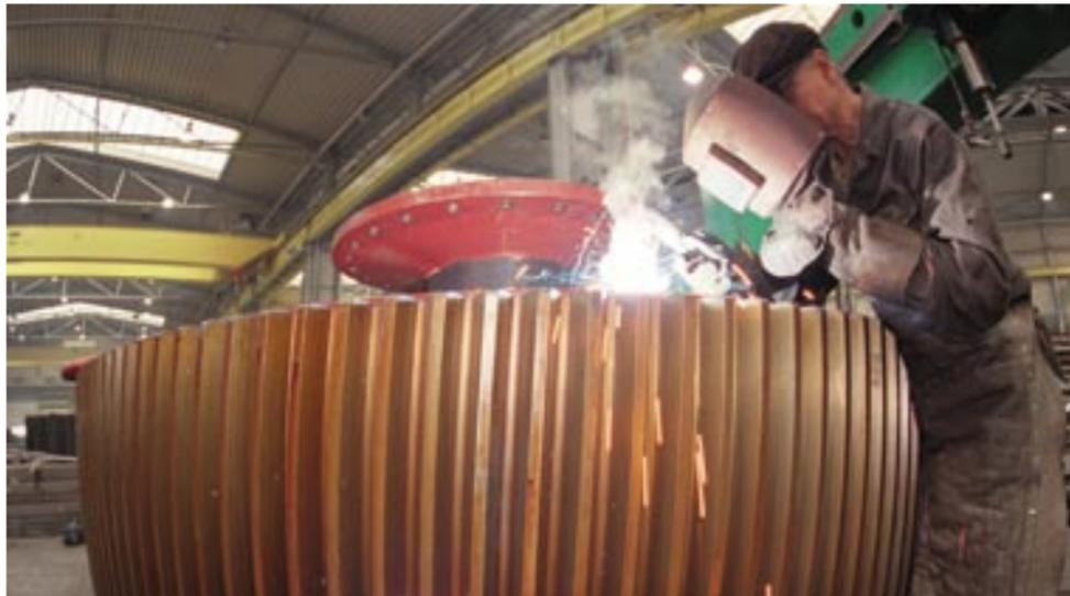
Ein Schweißer bearbeitet bei TAKRAF eine riesige Getriebestufe für einen Schaufelradbagger.
